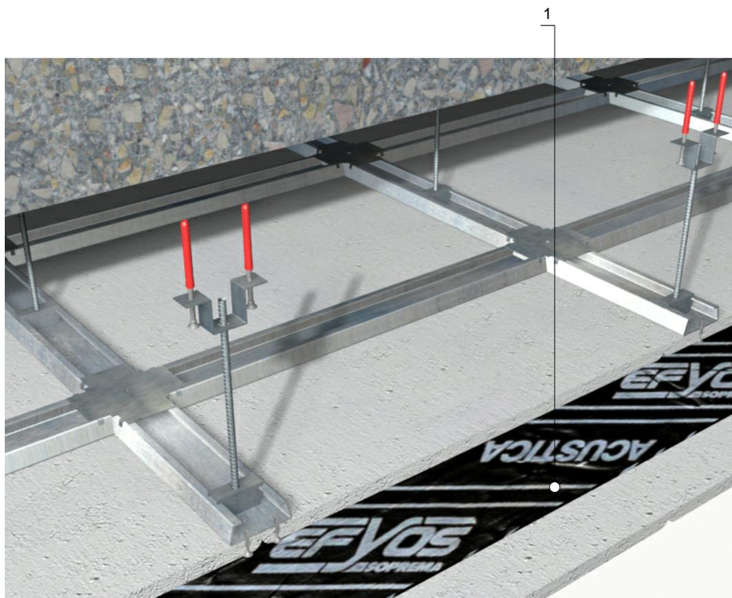
**1 mt16pts050Db** Lámina viscoelástica autoadhesiva de alta densidad Insoplast AA 6 "SOPREMA", de 4 mm de espesor.
